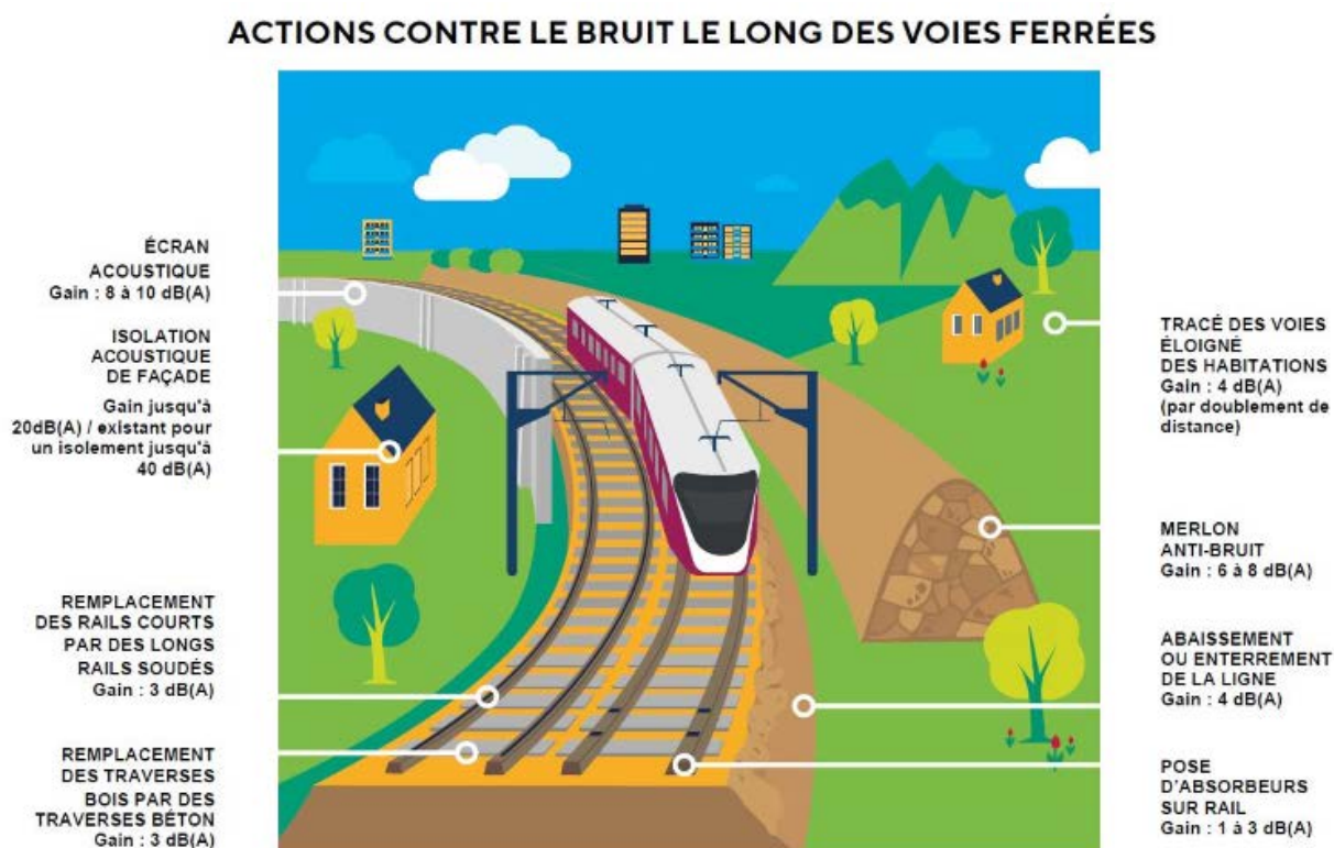
Figure 35: Actions contre le bruit le long des voies ferrées (source : SNCF-Réseau)
